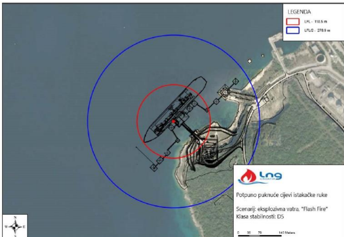
Slika 17. Zone ugroženosti uslijed ispuštanja PP-a i zapaljenja para formiranog oblaka (eksplozivna vatra) uslijed potpunog puknuća cijevi istakačke ruke, za vremenske prilike klase stabilnosti D5, s brzinom vjetra 5,6 m/s
