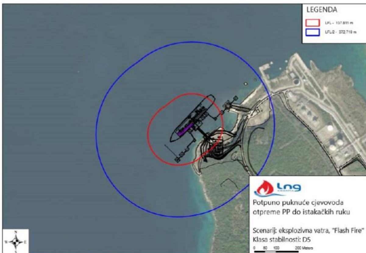
Slika 15. Zone ugroženosti uslijed disperzije i zapaljenja oblaka plina (eksplozivna vatra) uslijed potpunog puknuća cjevovoda otpreme PP do istakačkih ruku, za vremenske prilike klase stabilnosti D5, s brzinom vjetra 5,6 m/s
