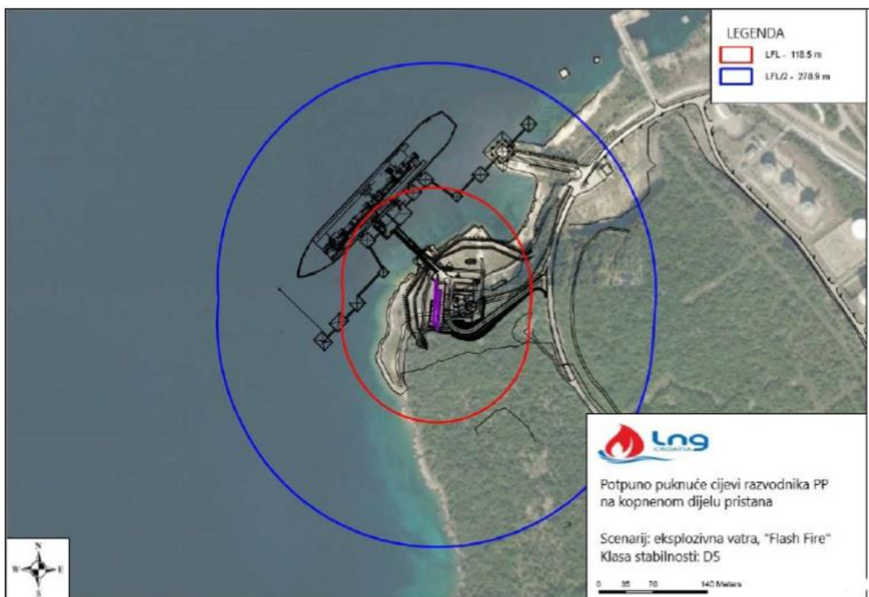
Slika 12. Zone ugroženosti uslijed ispuštanja PP-a i zapaljenja oblaka plina (eksplozivna vatra) uslijed potpunog puknuća cijevi razvodnika PP na kopnenom dijelu pristana, za vremenske prilike klase stabilnosti D5, s brzinom vjetra 5,6 m/s
