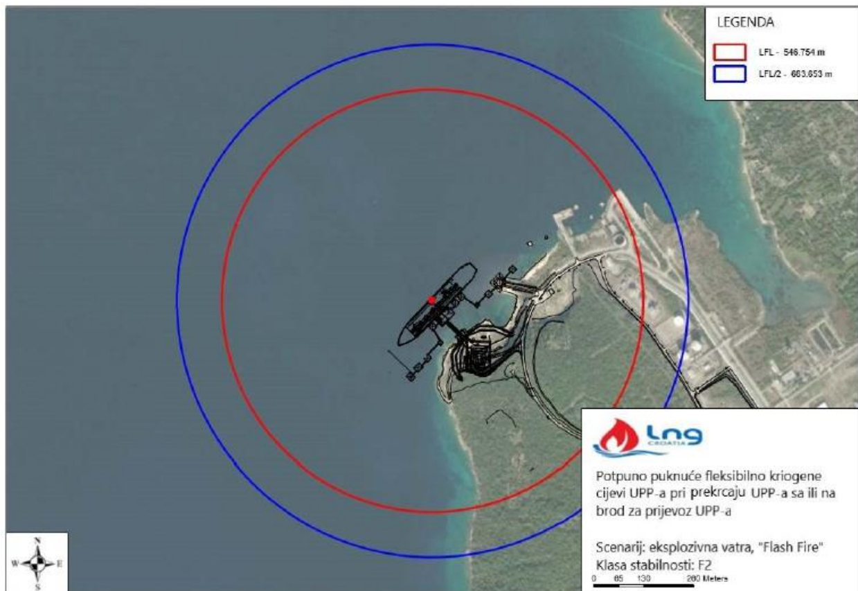
Slika 16. Zone ugroženosti uslijed istjecanja UPP-a i zapaljenja para formiranog oblaka para UPP-a (eksplozivna vatra) uslijed potpunog puknuća fleksibilne kriogene cijevi UPP-a prilikom prekrcaja UPP-a s ili na brod za prijevoz UPP-a, za vremenske prilike klase stabilnosti F2, s brzinom vjetra 1,6 m/s
