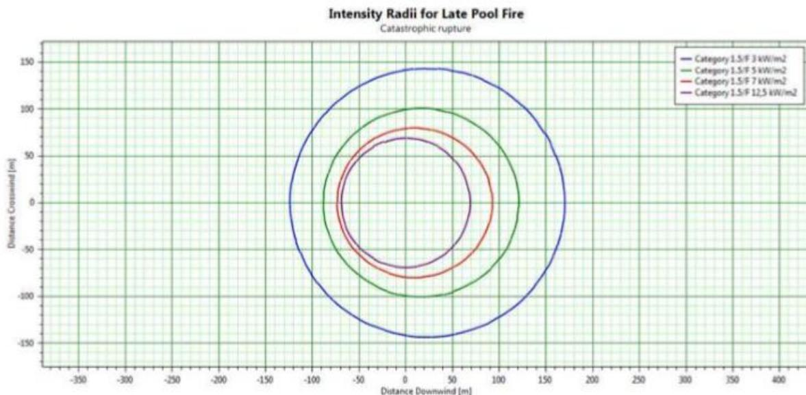
Slika 28. Radijus intenziteta toplinskog zračenja za požar lokve
