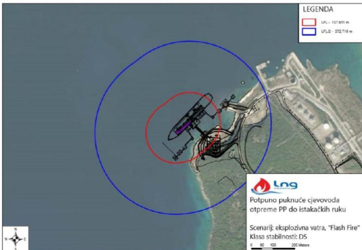
**Slika 10. Zone ugroženosti uslijed disperzije i zapaljenja oblaka plina (eksplozivna vatra) uslijed potpunog puknuća cjevovoda otpremne PP do istakačkih ruku, za vremenske prilike klase stabilnosti D5, s brzinom vjetra 5,6 m/s**
