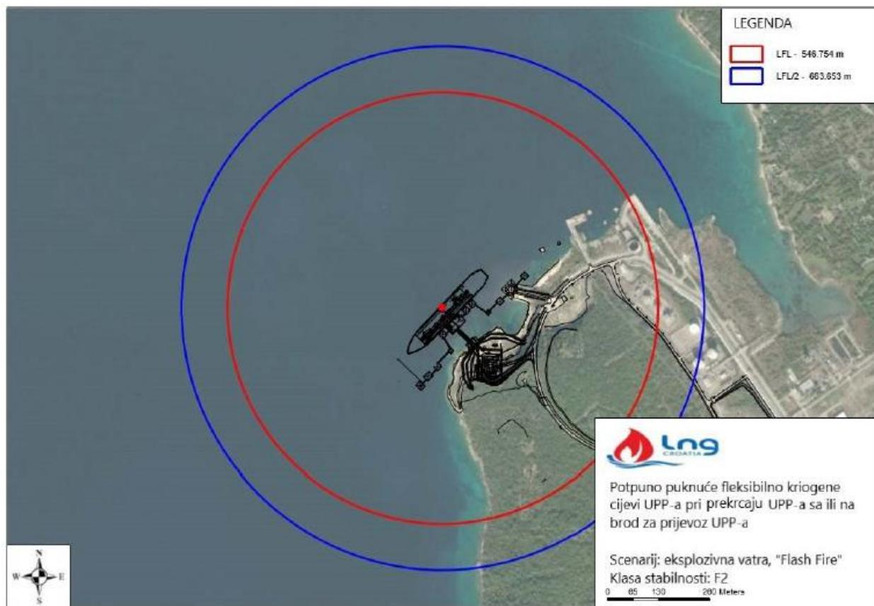
**Slika 11. Zone ugroženosti uslijed istjecanja UPP-a i zapaljenja para formiranog oblaka para UPP-a (eksplozivna vatra) uslijed potpunog puknuća fleksibilne kriogene cijevi UPP-a prilikom prekrcaja UPP-a s ili na brod za prijevoz UPP-a, za vremenske prilike klase stabilnosti F2, s brzinom vjetra 1,6 m/s**
