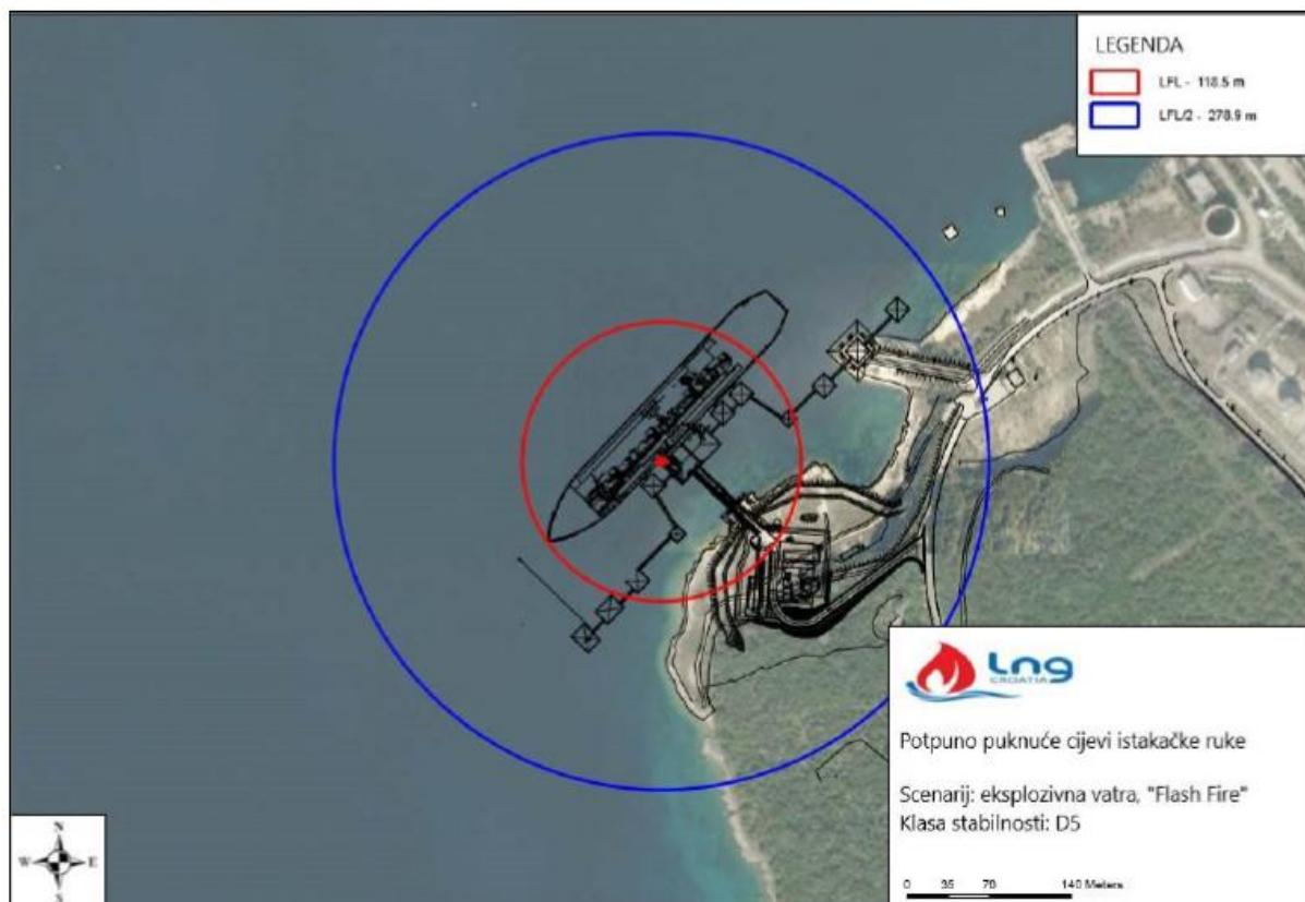
**Slika 12. Zone ugroženosti uslijed ispuštanja PP-a i zapaljenja para formiranog oblaka (eksplozivna vatra) uslijed potpunog puknuća cijevi istakačke ruke, za vremenske prilike klase stabilnosti D5, s brzinom vjetra 5,6 m/s**
