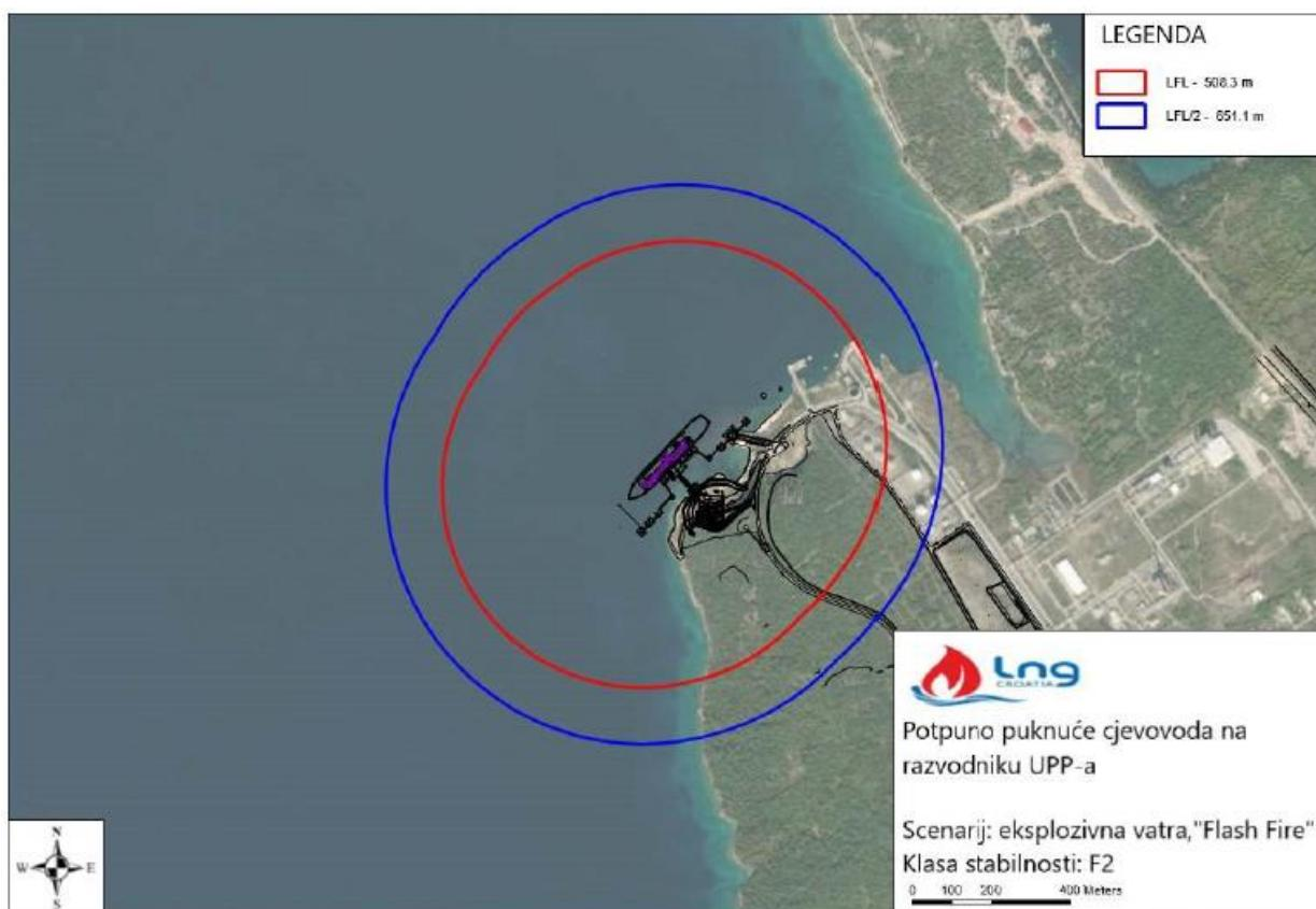
Slika 6. Zone ugroženosti uslijed istjecanja UPP-a i zapaljenja para formiranog oblaka (eksplozivna vatra) uslijed potpunog puknuća cjevovoda razvodnika UPP-a, za vremenske prilike klase stabilnosti F2, s brzinom vjetra 1,6 m/s
