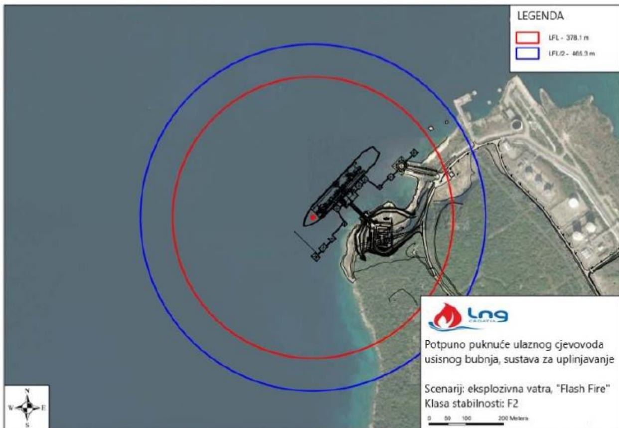
**Slika 8. Zone ugroženosti uslijed istjecanja UPP-a i zapaljenja para formiranog oblaka (eksplozivna vatra) uslijed potpunog puknuća ulaznog cjevovoda usisnog bubnja, sustava za uplinjavanje za vremenske prilike klase stabilnosti F2, s brzinom vjetra 1,6 m/s**
