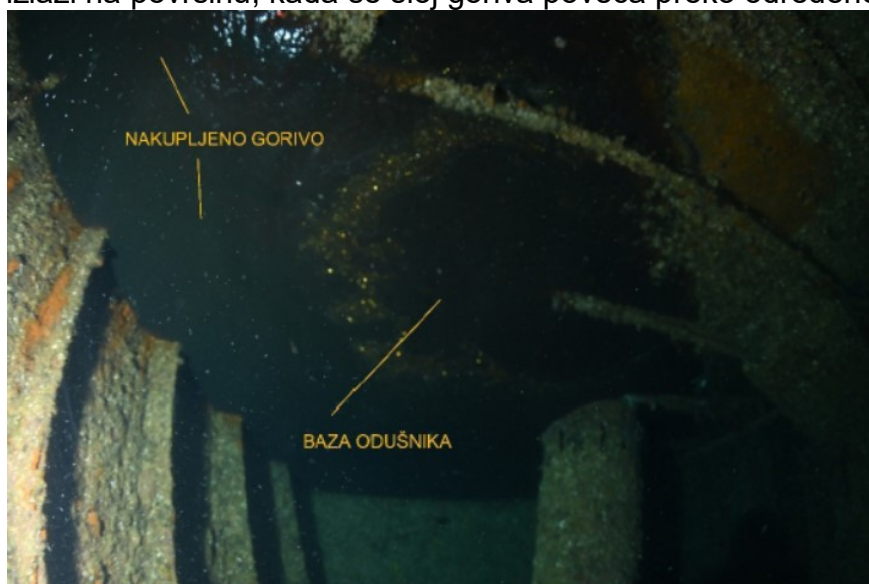
Slika 5. Sloj zarobljenog goriva na stropu. Vidi se baza odušnika kroz kojega gorivo povremeno izlazi na površinu, kada se sloj goriva poveća preko određene debljine.
