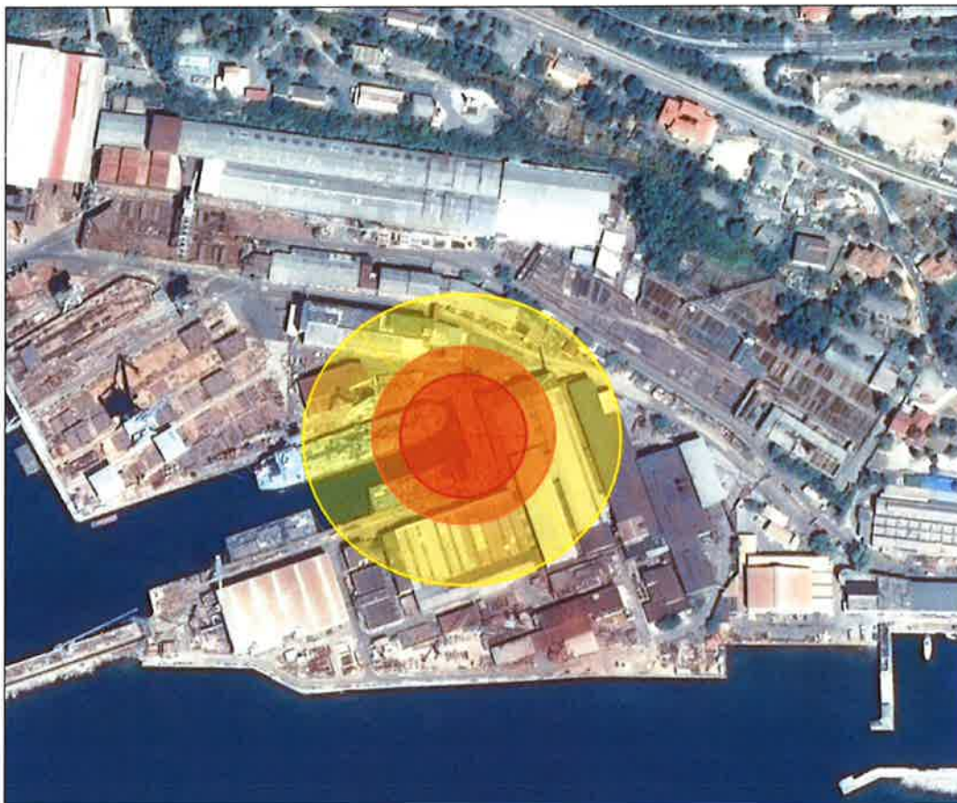
Slika 11. Prikaz zone ugroženosti u slučaju požara dizel goriva, 3. Maj Brodogradilište d.d.
