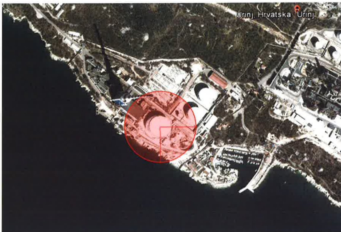
Slika 30. Zone ugroženosti uslijed istjecanja i zapaljenja teško loživog ulja iz spremnika C1 na lokaciji Termoelektrane Rijeka
