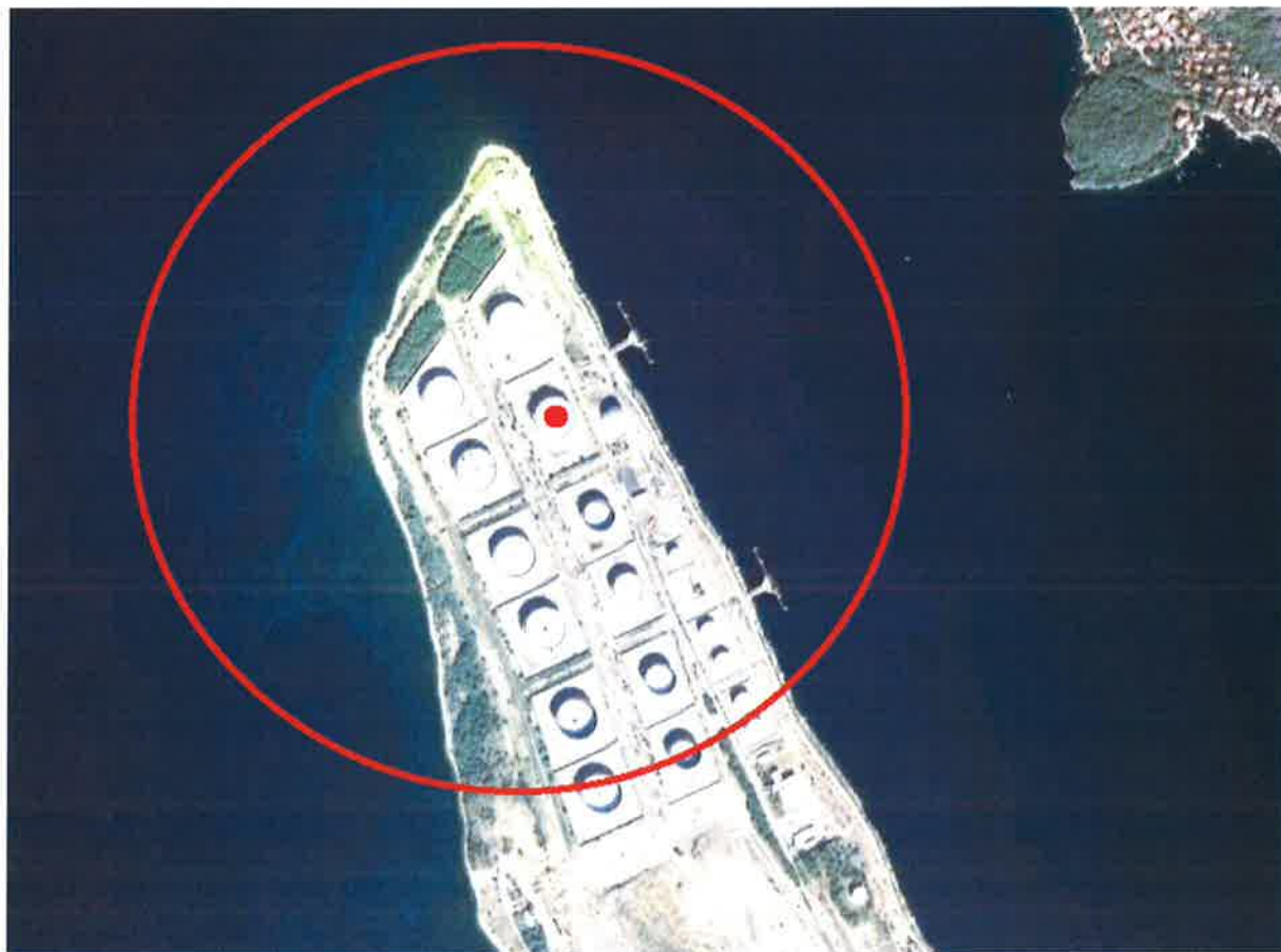
Slika 33. Doseg utjecaja iznenadnog događaja koji uključuje naftu na lokaciji Terminala Omišalj
