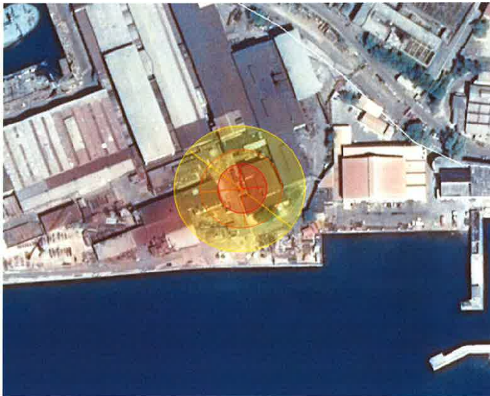
Slika 12. Prikaz zone ugroženosti u slučaju ispuštanja i zapaljenja prirodnog plina, 3. Maj Brodogradilište d.d.
