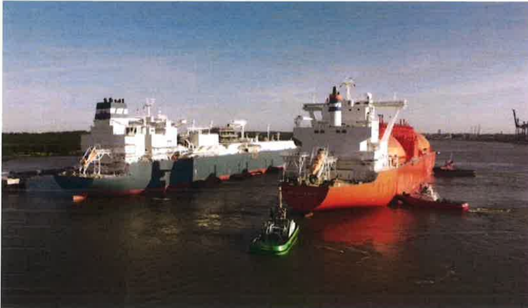
Slika 3. FSRU i LNG brod
