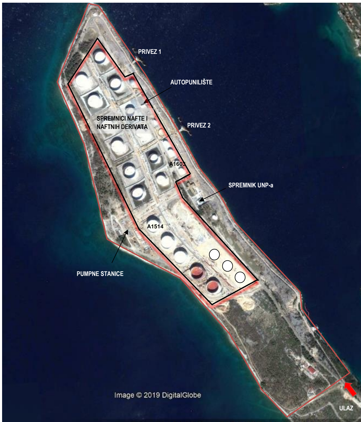
Slika 6. Rizični dijelovi područja postrojenja Terminal Omišalj
