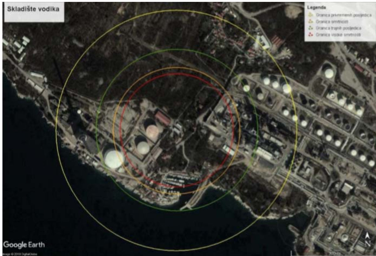
Slika 22. Zone ugroženosti prilikom eksplozije 0,08 t vodika (10 baterija) u skladištu vodika
