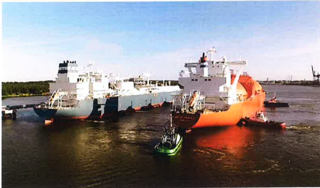
Slika 3. FSRU i LNG brod
