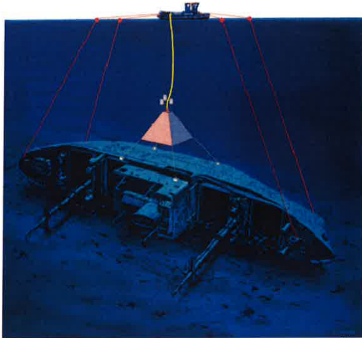
Slika 1. Izgled i položaj sabirnika iznad olupine. Sabirnik je povezan sa površinom pomoću rebraste fleksibilne cijevi otporne na tlak okolne vode.
